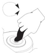
2. Koristeći plastičnu pipetu, kapnuti uzorak na površinu prizme. Napuniti prsten do vrha. Beleška: Ukoliko se temperatura uzorka razlikuje značajno od temperature aparata, čekati odprilike 1 minut da bi se temperature izjednačile.
