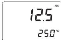
Beleška: "ATC" znak trepti i automatska kompenzacije temperature je isključena ukoliko temperatura pređe raspon 10-40 °C / 50-104 °F.
