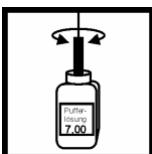
Staviti sondu u **zeleni** pufer **pH 7,00** i sacekati dok se vrijednost u display-u stabilizira.
