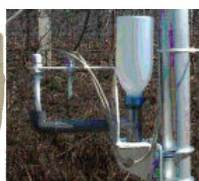
Ukoliko je rjec o **T-Warner rain**, opremljen je kišomjerom. Ako posedujemo **T-Warner ice**, isti je opremljen sa
